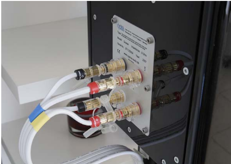
Bild 3: Hochwertig bestücktes Anschlussterminal, Signale für Hoch und Tiefmitteltöner werden getrennt über WBT Klemmen zugeführt
